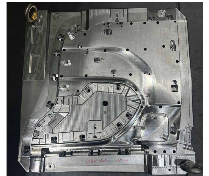
미주정밀 테스트 가공의 대상품인 자동차 도어 트림(Door Trim) 사출 금형
